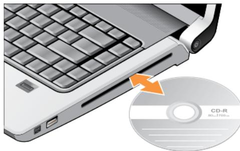
Pour éjecter un disque du lecteur, appuyez doucement sur la commande d'éjection
